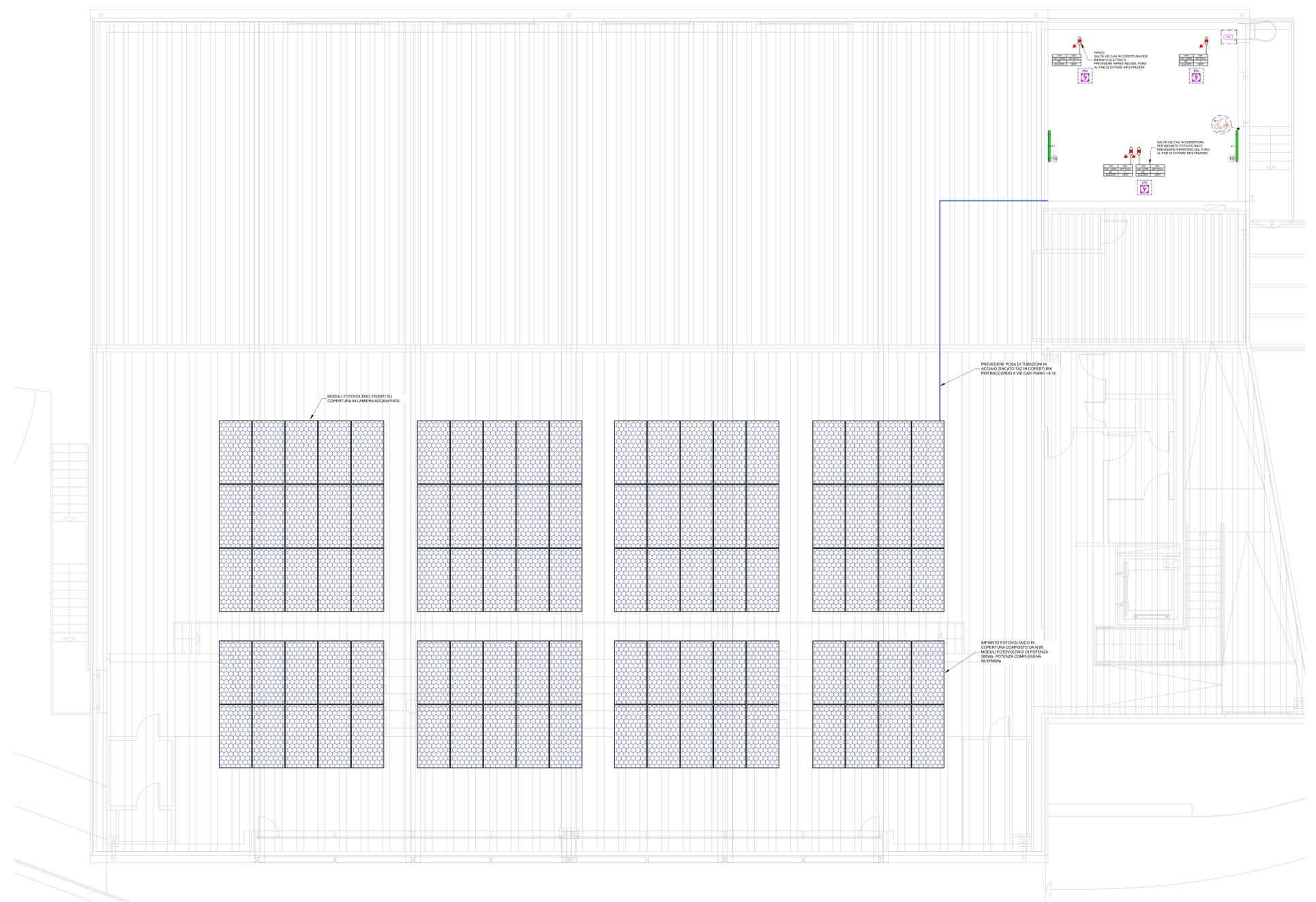
MODULI FOTOVOLTAICI FISSATI SU COPERTURA IN LAMIERA GRIGIA
